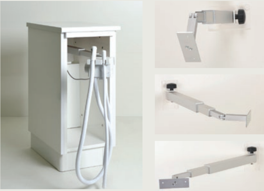
Bras télescopique avec tête articulée. Fermé 370 mm, ouvert 890 mm.
